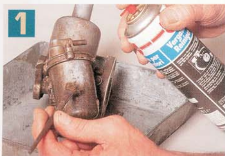
1 Zum Säubern wird ein spezieller Vergaserreiniger mit einem Pinsel aufgetragen. Nach dem Trockenwischen sollten die Vergaser mit Druckluft ausgeblasen werden
