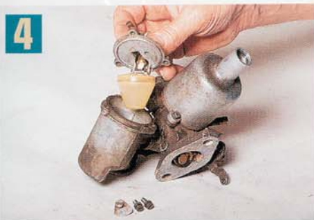
4 In der Schwimmerkammer werden die Dichtigkeit des Schwimmers, seine Freigängigkeit und die Funktion des Ventils überprüft. Teile sind in aller Regel erhältlich
