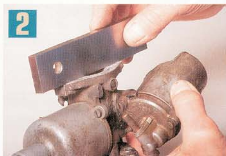
2 Die Sichtprüfung gehört dazu: Mit einem Haarlineal lassen sich die Flanschflächen auf Verzug überprüfen. Auch auf Risse und Brüche ist zu achten
