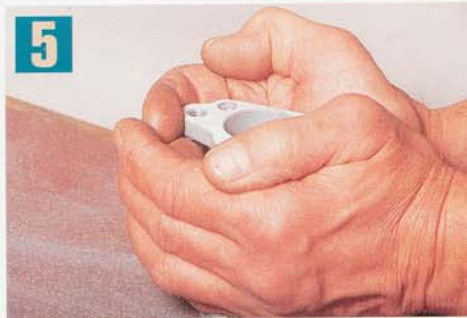
5 Mit festem Griff werden die Flanschflächen abgezogen. Ideal ist Schleifpapier mit 150er Körnung, das auf eine Glasplatte geklebt ist
