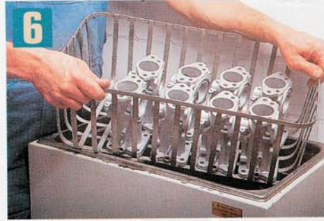
6 Profis reinigen die Vergaserkörper nach dem Glasperlenstrahlen in einem beheizbaren Ultraschallbad. Auch kleinste Verschmutzungen werden so sicher gelöst
