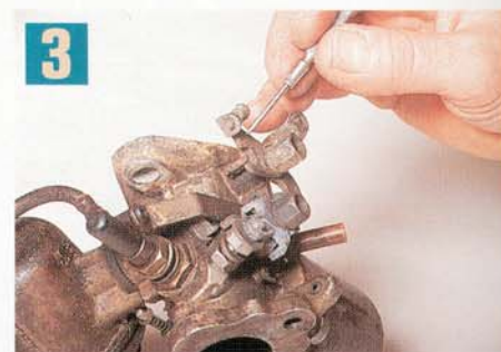
3 Empfindliche Anbauteile wie Drosselklappenhebel verbiegen gerne. Im Zweifelsfall sollten sie ausgetauscht werden – meist reichen Gebrauchtteile aus
