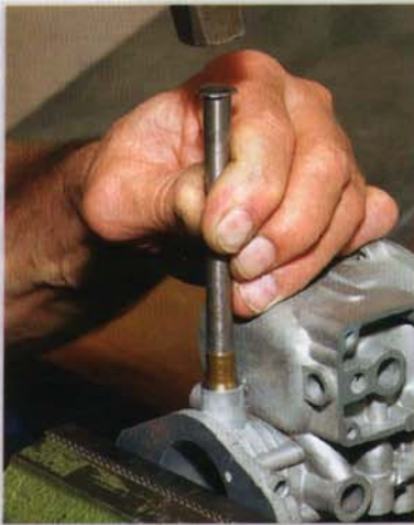
Neue Drosselklappen-Lagerbuchsen werden ins Gehäuse getrieben
