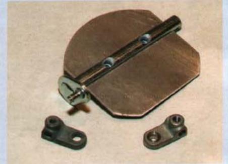
Fehlkonstruktion: Der Starterklappenhebel aus Zinkdruckguss erhält eine stabile Stahlbuchse
