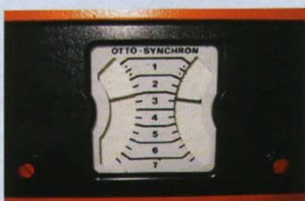
Unsere beiden Vergaser zeigen nach der Grundeinstellung schon gute Werte
