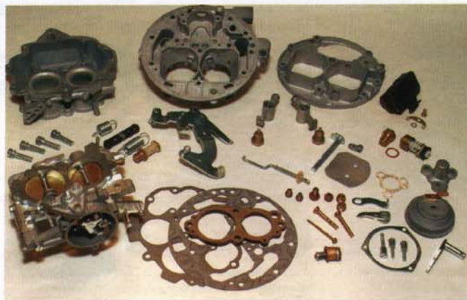
Puzzle für Fortgeschrittene: Alle Gehäuseteile sind glasperlgestrahlt und gereinigt, andere Bauteile wurden galvanisch verzinkt – jetzt kann der Zusammenbau beginnen
