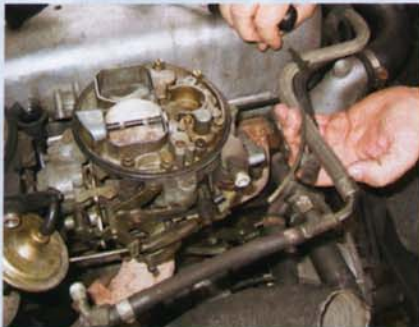
Zuerst werden die Benzinleitung und der Unterdruckanschluss des Verteilers gelöst
