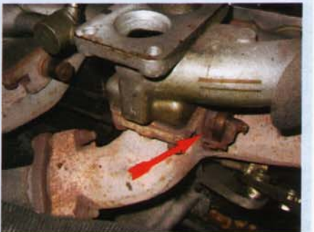
Diese Bimetallfeder sollte in Ordnung sein: Sie steuert die Vergaservorwärmklappe im Auspuff
