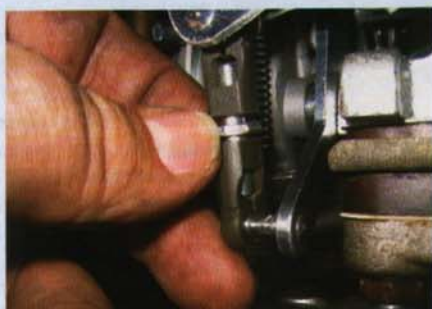
Zum Synchronisieren werden die Schrauben am Drosselklappengestänge gedreht
