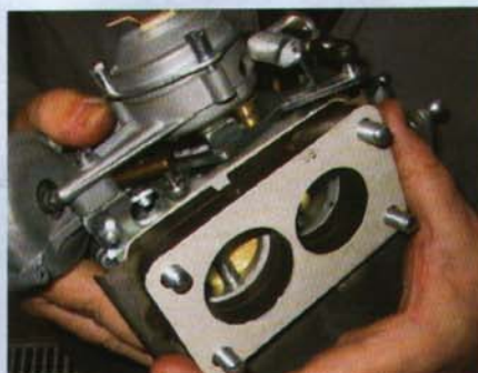
...Wärmeleitbleche und Dichtungen als „Paket“ auf den überholten Vergaser stecken
