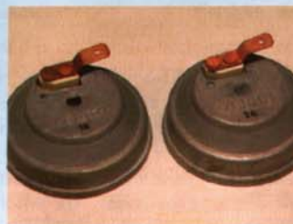
Die Heizleistung der Startautomatik ist auf den Deckeln vermerkt
