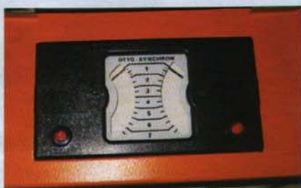
Natürlich müssen die beiden Zeiger des Testgerätes im Ruhezustand auf Null stehen
