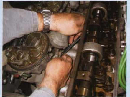
Bei abgenommenem Ventildeckel sind die Vergaserflanschschrauben leichter zugänglich
