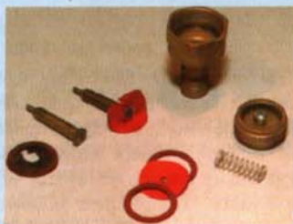
Das Treibstoffrücklaufventil: Oft ist die kleine runde Membran defekt
