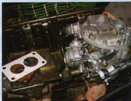
Damit keine Dichtung falsch herum aufgelegt wird, sollte man Isolierflansche...
