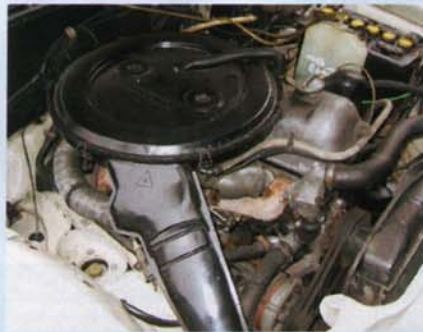
Im Motorraum des 280 S verstecken sich die Vergaser unter dem riesigen Luftfilter
