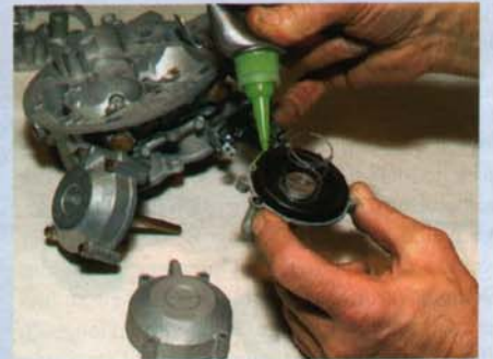
Bei den Unterdruckmembranen der zweiten Stufe verwendet Bob zur Sicherheit etwas Dichtpaste
