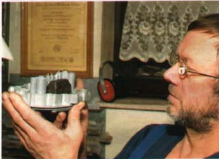
Wenn alle Kanten parallel zum Gehäuse stehen, stimmt der Schwimmerstand automatisch
