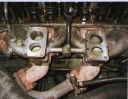
Die beiden Wärmeleitbleche und die vier Isolierflansche werden beiseite gelegt
