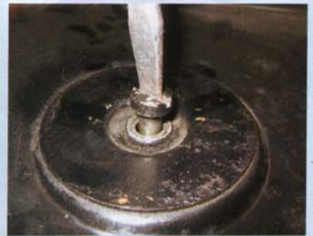
Vorsicht: Wenn die Luftfilterschrauben vernudelt werden, ist der Vergaserdeckel Schrott!
