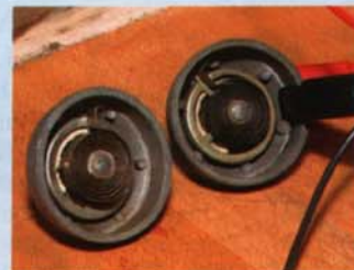
Ein Zwölfvolt-Ladegerät zeigt, ob sich die Bimetallfedern wirklich bewegen
