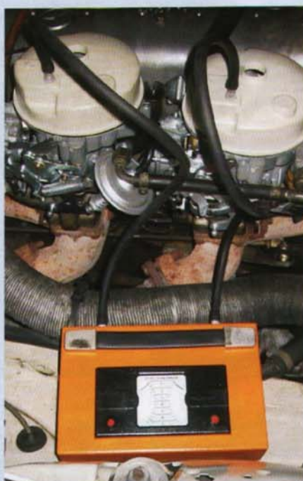
Der Synchrontester wird an zwei spezielle Glocken für INAT-Vergaser angeschlossen
