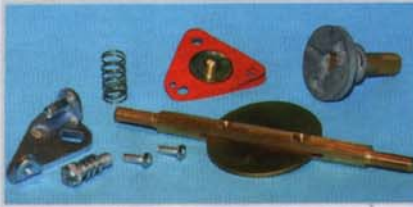
Übersichtlich: Das sind alle Neuteile, die zum Überholen der Porsche-Gasfabrik notwendig sind
