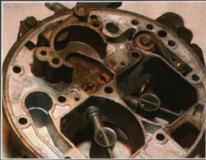
In der Mitte des Platineblocks liegen die beiden Luftkorrekturdüsen, daneben das Leerlaufrohr
