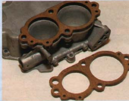
Ein dicke Dichtung trennt Schwimmergehäuse und Drosselklappenteil. Bei allen Dichtungen...
