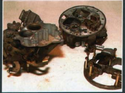
Die drei Hauptbauteile: Schwimmergehäuse, Platineblock und Vergaserdeckel (von links)
