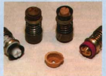
Kolben der Beschleunigerpumpe mit Membranen aus Gummi oder Leder
