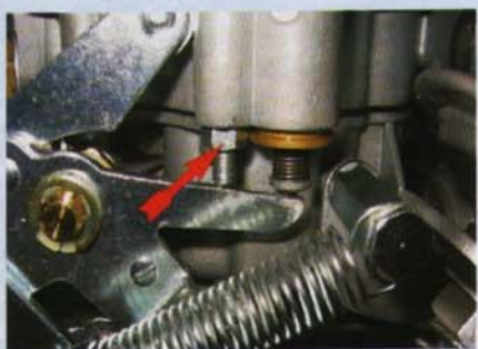
Hier nicht synchronisieren! Dieser Anschlag dient nur zur Einstellung des Belüftungsventils
