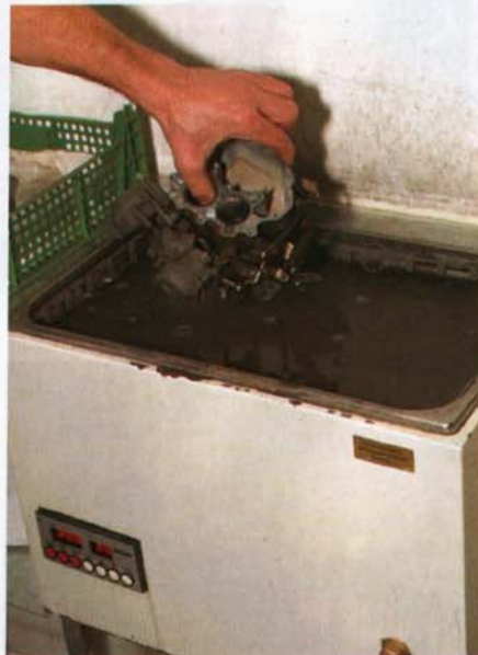
Das Ultraschallbad entfernt selbst hartnäckigste Verschmutzungen innen und außen
