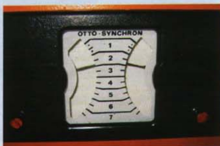
Nach ein wenig Feinjustierung ist der Unterdruck auf beiden Seiten nahezu gleich
