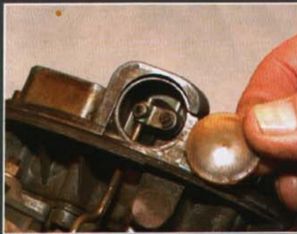
Um den Deckel abheben zu können, muss zuerst der kleine Starterklappenhebel entfernt werden
