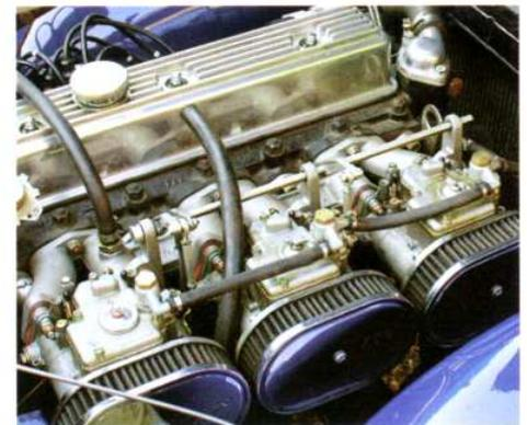
Nach dem Einbau von Sportluftfiltern müssen die Vergaser neu bedüst und abgestimmt werden
