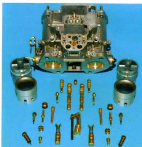
Mit verschiedenen Düsen und Lufttrichtern wird der Vergaser auf das jeweilige Auto abgestimmt
