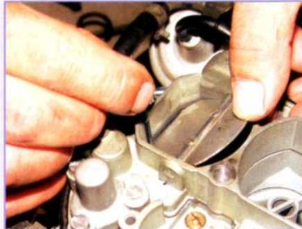
Mit einem 3,5-Millimeter-Bohrer wird der Spalt für die Minimalöffnung der Klappe gemessen
