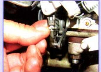
Beim INAT wird die Drosselklappe an diesem Gestänge eingestellt
