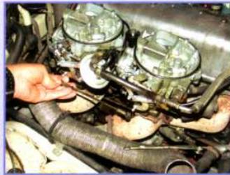
Die Verbindungsgestänge der beiden Vergaser werden ausgehängt
