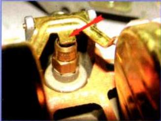
Durch Verbiegen dieser Lasche wird der Schwimmerstand eingestellt
