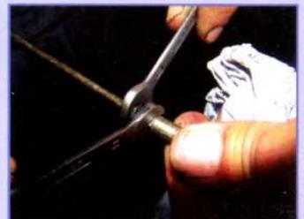
Die Verbindungsstange wird in der Länge genau eingestellt
