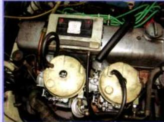
Synchrontester zeigen an, ob der Unterdruck beider Vergaser gleich ist
