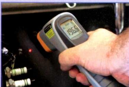
Das Infrarot-Thermometer misst berührungsfrei. Der sechste Zylinder des BMW 328 läuft...
