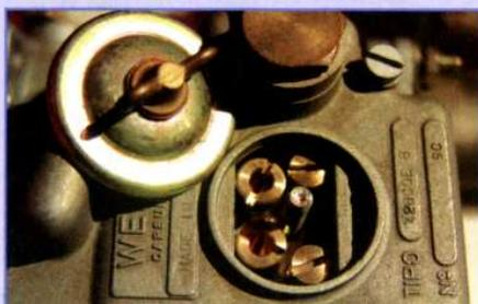
Schnelle-Eingreifklappe: Weber-Vergaser lassen sich bei Bedarf sehr leicht umbedüsen
