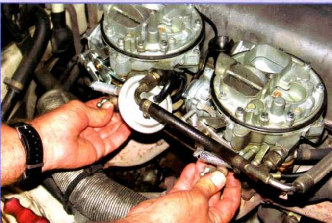
Die Stange muss zwischen den beiden Vergasern absolut zug- und druckfrei einrasten – sonst war die ganze Synchronisierungsarbeit vergeblich
