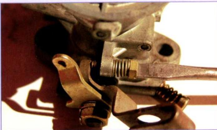
Die Schraube für das Leerlaufgemisch läuft spitz zu und hat im Vergasergehäuse ein konisches Gegenstück. Wie ein Wasserhahn lässt sie mehr oder weniger Sprit passieren. Die Spitze wird oft durch zu starkes Festziehen beschädigt – dann ist eine zuverlässige Einstellung unmöglich
