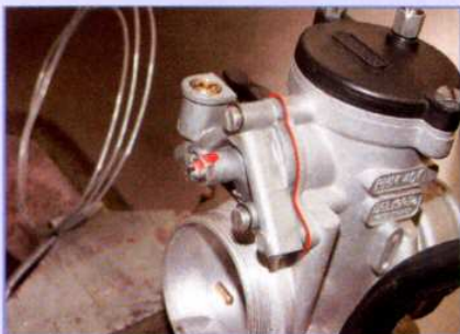
Nicht zuviel des Guten: Die Einstellschraube sollte nur in kleinen Schritten bewegt werden
