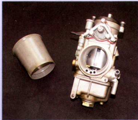
Verschleißfördernd und oft der Quell allen Übels: offene Trichter für den Rennstreckengebrauch
