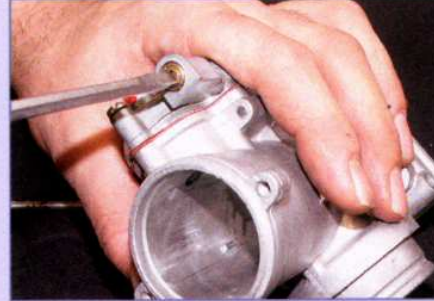
Mit der Montage der beiden Rückschlagventile ist die Beschleunigerpumpe wieder komplett
