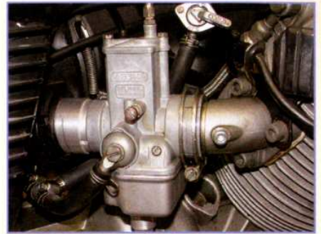
...32er Amal in einer Norton (links) oder der Flachschieber einer Guzzi 850 T3 (auch Dellorto)
