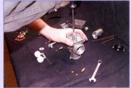
Wie hier am Mischrohr gilt: Verwenden Sie nur gutes und genau passendes Werkzeug!
