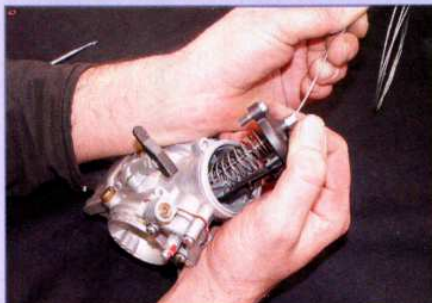
Es muss flutschen: Beim Einführen des Schiebers in den Schacht darf nichts klemmen
