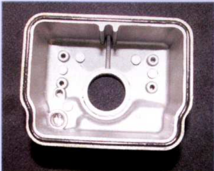
Kein Staub, keine Lackteilchen: So sauber muss eine Schwimmerkammer aussehen
