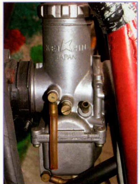
Im Gegensatz zum Dellorto weist der japanische Keihin-Vergaser eine Lufteinstellschraube auf
