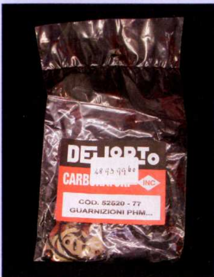
Ohne geht gar nichts: Der passende Dichtsatz ist die Grundlage jeder Vergaser-Überholung
