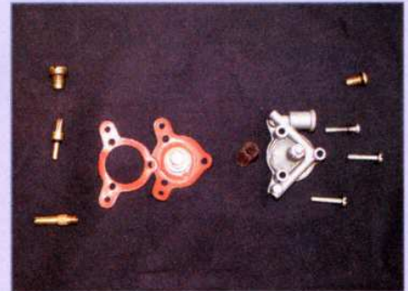
Kein Hexenwerk: Die Beschleunigerpumpe besteht nur aus wenigen Teilen
