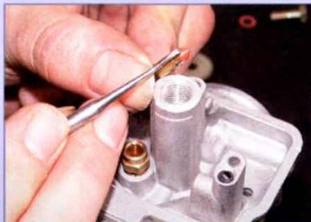
Kleine Ursache, große Wirkung: Eine defekte Schwimmernadeldichtung fettet das Gemisch an
