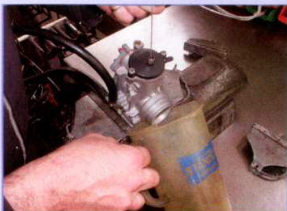
Beim Einstellen der Beschleunigerpumpe wird der Zug gehalten, bis kein Sprit mehr kommt
