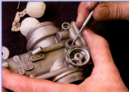
Filigran: Christian Bauer entfernt den O-Ring der Standgasschraube mit Zahnarzt-Werkzeug
