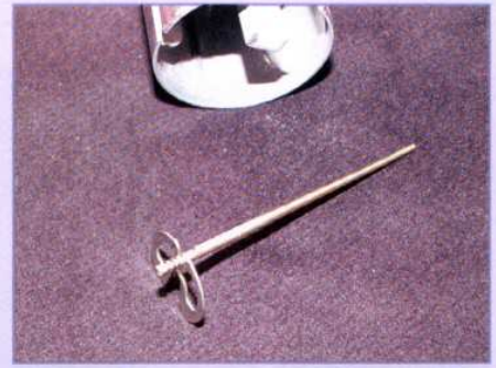
In welcher Kerbe steckt der Klipp? Notieren Sie den Wert, er erleichtert später die Einstellung
