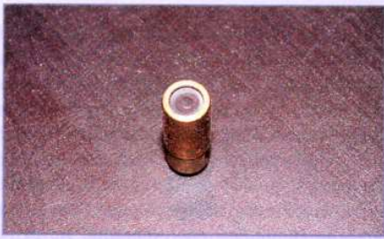
Am Ende der Lebensdauer: Die Kaltstartdichtung zeigt deutliche Setzspuren. Eine Neue muss her
