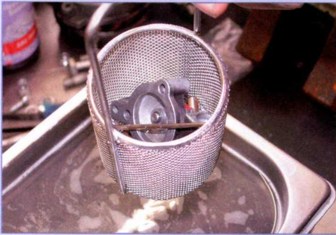
Heraus kommen die Teile wie neu! Das Ultraschallbad ist geradezu ideal geeignet, um viele kleine Bauteile zu säubern
