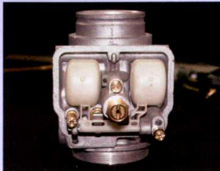
Um den Schwimmer auszubauen, wird die Achse mit einer Spitzzange herausgezogen
