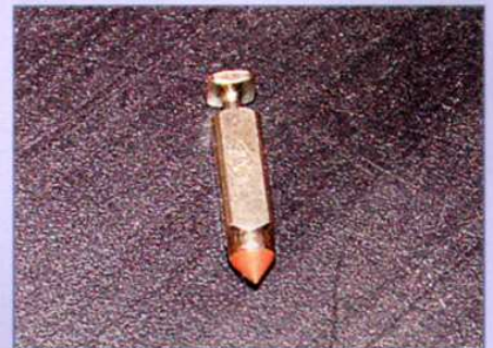
Die Schwimmernadel. Wenn Zweifel an der Dichtheit bestehen, lieber austauschen!
