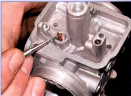
Sie wird gelegentlich vergessen: die kleine Fibernichtung des Nadelventils
