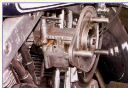
Auch das gab es: Drosselklappe statt Schieber am S&S-Vergaser einer Harley Electra Glide
