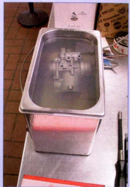
So macht es der Profi: gründliche Reinigung aller Vergaserteile im Ultraschallbad
