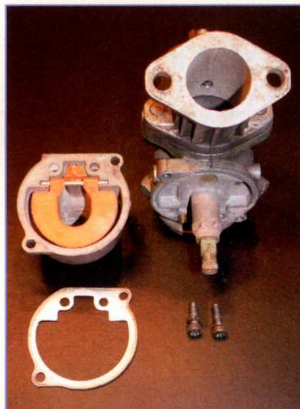
Auch bei der Norton Commando anno 1969 bestand der Schwimmer schon aus Kunststoff
