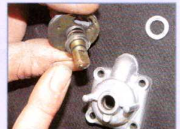
...Scheibe mitsamt der Achse aus dem Gehäuse gedrückt werden
