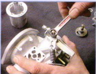
Vor dem Haltearm für den Gaszug muss der Drosselhebel weg
