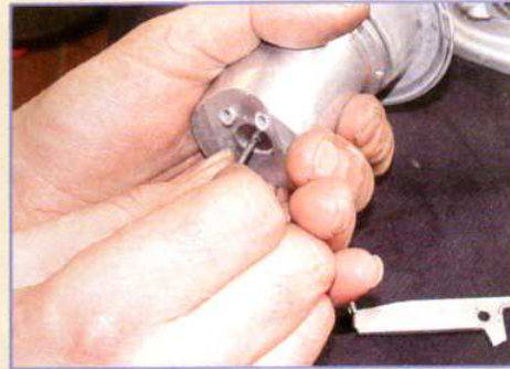
Nichts für Grobmotoriker: Um die Düsennadel in die richtige Position zu bringen, ist Gefühl gefragt
