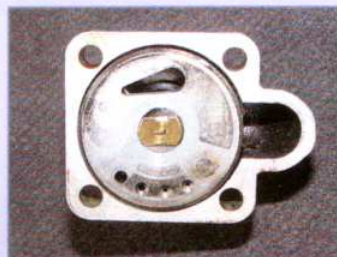
Vorsicht: Die Scheibe darf später nicht verdreht eingebaut werden
