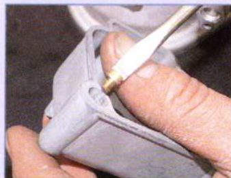
In der Ecke der Schwimmerkammer wird die Chokedüse gern übersehen
