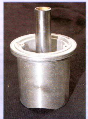
Die Diagnose: Leichte Schleifspuren und Kratzer am Schieber sind normal
