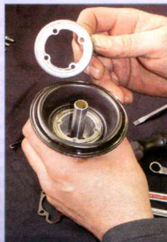
Nach dem Entfernen des Klemmrings ist die Membran schon ausgebaut
