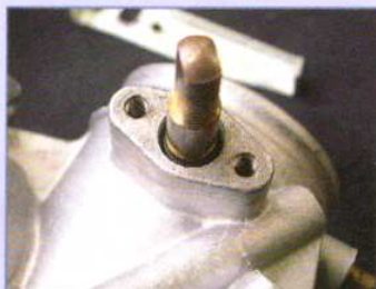
Kein Spiel, leichtgängig und dicht: die Drosselklappenachse ist okay
