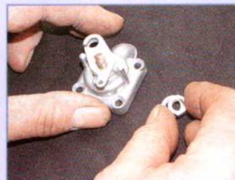
Nach dem vorsichtigen Abziehen des Chokehebels kann die...
