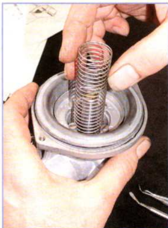
...und Membran. Nach dem Setzen der Rückstellfeder wird der...
