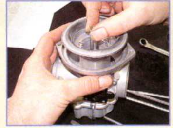
Achten Sie bei der Montage des Schiebers auf den Sitz von Nadel...
