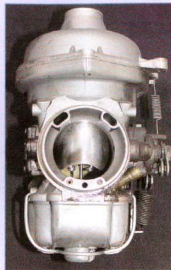
Gut zu sehen: die Ansaugöffnungen für den Unterdruckmechanismus
