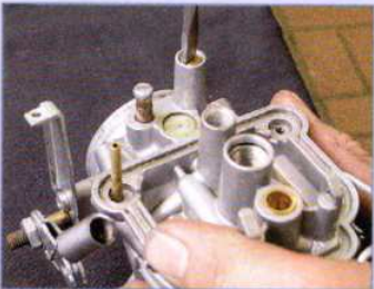
Gut merken: die Stellung der Leerlaufgemischschraube
