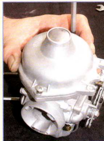
...Domdeckel montiert. Beide Schrauben abwechselnd anziehen!
