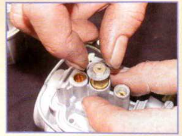
Schritt für Schritt beim Zusammenbau: Die vier Bilder zeigen die richtige Einbaureihenfolge und die Lager der drei Zerstäuberteile und der Hauptdüse
