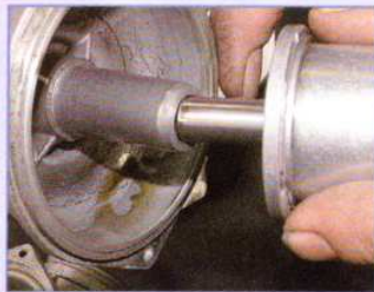
Hat die Schieberführung Spiel? Dann sind Schieber und Deckel Schrott
