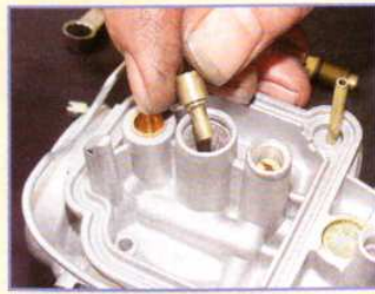
Schritt für Schritt beim Zusammenbau: Die vier Bilder zeigen die richtige Einbaureihenfolge und die Lager der drei Zerstäuberteile und der Hauptdüse
