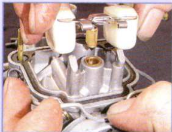
Vorsicht beim Abheben: Die Nadelventilaufnahme ist empfindlich
