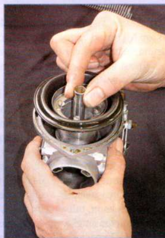
...noch in Ordnung? Der Schieber kann leicht herausgezogen werden
