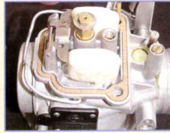
Die Dichtung der Schwimmerkammer wird bei der Überholung erneuert
