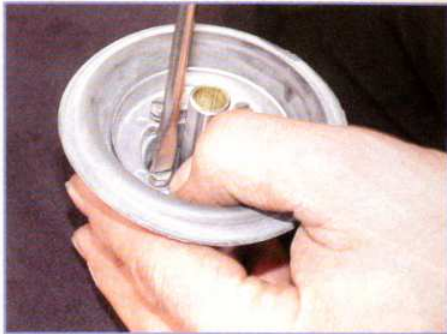
Gleichmäßig über Kreuz anziehen: Die vier Schrauben des Membranklemmrings
