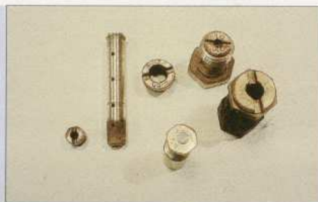
Von links: Leerlaufluftdüse, Mischrohr, Starterluftdüse (oben), Leerlaufkraftstoffdüse (unten), Düsenstockhalter mit Hauptdüse (oben)...
