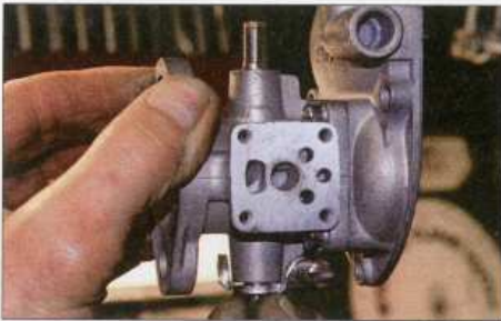
Das Drosselklappengehäuse wird an jeder Ecke von einer Schraube gehalten. Mit den ganzen Betätigungshebeln geht es weiter
