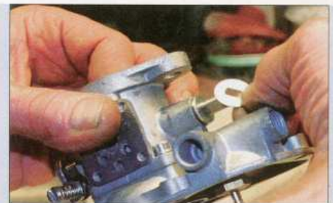
Die Drosselklappenwelle muss in der Regel mit Ausgleichsscheiben und Sicherungsblech so ausgerichtet werden, das ihr etwas...
