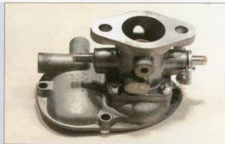
Der Flansch, der zur Ansaugbrücke führt, wird ebenfalls neu plan geschliffen. An diesem Punkt ist die Vergaserüberholung halb fertig
