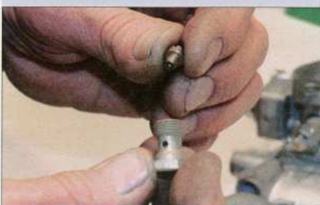
Der Düsenstockhalter nimmt die Hauptdüse auf. Wer sich über den Zustand der Düse nicht sicher ist, sollte sie auswechseln.
