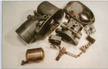
Profi-Tipp aus Erfahrung: Bob verbindet alle Vergaserteile vor dem Glasperlstrahlen mit einem Draht. Das verhindert „Verluste“
