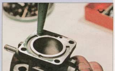
Beim Aufsetzen des Drosselklappengehäuses auf den Schwimmerkammerdeckel kommt hauchdünn Flüssigdichtung zum Einsatz
