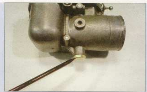
Fast alle „Agri“-Vergaser haben eine Ablass-Schraube am Düsenstockhalter, um Dreck und Wasser jederzeit bei Bedarf abzulassen
