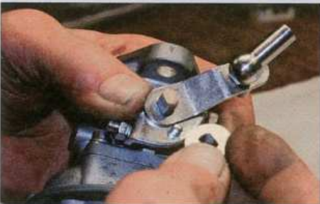
...Seitenspiel bleibt. Das geschieht wie hier, bevor auf der „Betätigungsseite“ das restliche Hebelwerk angebracht wird
