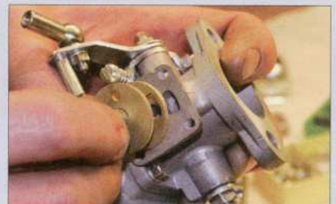
...ebenfalls gequetscht, nur zur Sicherheit. Beim Choke müssen die Belüftungslöcher genau übereinstimmen. Falls die Scheiben...
