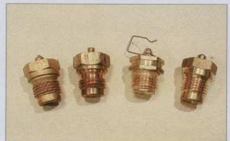
Eine Auswahl verschiedener Schwimmer-Nadelventile: Bei einem Traktor ist es ziemlich egal, welches Ventil man einsetzt
