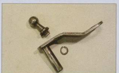
Nach rund 50 Jahren hat jeder Kugelkopf Spiel, wenn er nicht gar ganz verschlissen ist. Man kann ihn quasi ungesehen auswechseln
