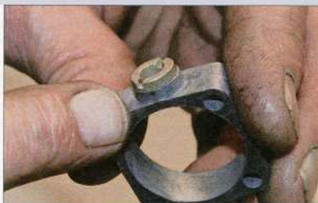
...um 180 Grad zueinander verdreht sind, kehrt sich die Funktion um. Im Bild das Choke-Außengehäuse mit der Starter-Luftdüse
