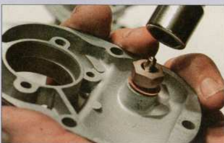
Beim Eindrehen des Schwimmernadelventils müssen die Unterlegscheiben die richtige Stärke haben, von ihnen hängt der Kraftstoffpegel ab
