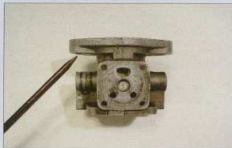
Das Auge erkennt es nicht sofort, aber viele Vergasergehäuseteile sind zu fest angezogen. Die Folge: Der Flansch wölbt sich, wird rund
