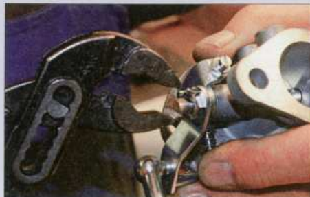
Und immer das Sichern durch Umbiegen des Blechs nicht vergessen. Die Gewinde-Enden der Drosselklappenschrauben haben wir...
