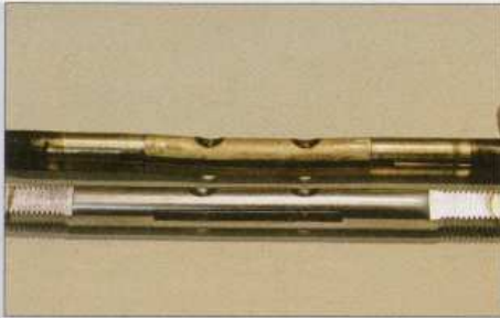
Eine alte, eingelaufene Drosselklappenwelle, daneben die neue hartverchromte. Auch hier gilt: Nach über 50 Jahren ist Ersatz gefordert
