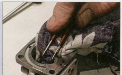
Deshalb wird auch nach dem Eindrehen der Schrauben noch einmal je der Kopf und die gesamte Umgebung sorgfältig gereinigt
