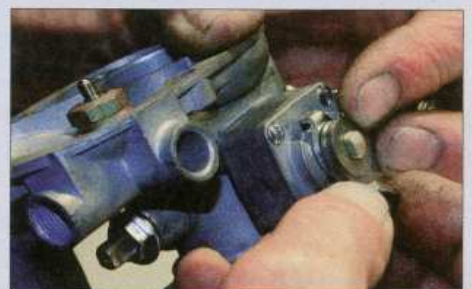
Ist das Gehäuse samt Innenleben befestigt, erfolgt die Montage des Hebelwerks. Spätestens jetzt machen sich die Markierungen nützlich
