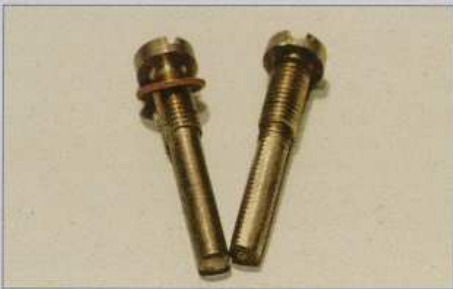
Rechts die originale Schwimmerhalterung, eine abgedrehte Schraube: Sie ist verschlissen – und zwar dort, wo das Gewinde ganz fehlt
