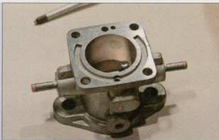
... nach der Montage auf einmal fest. Das Mittel neigt zur Kapillarwirkung und zieht sich fluchs zwischen Welle und Gehäuse – und härtet aus
