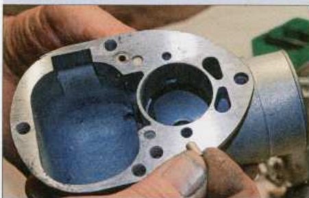
Das Einsetzen der Führungshülse in das plan geschliffene Schwimmergehäuse sollte jetzt erfolgen, ehe der neue Venturi eingesetzt wird
