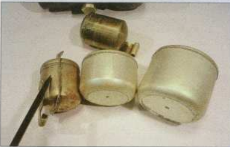
Schwimmer können durch Microrisse undicht werden. Dringt Benzin in sie ein, verändert sich ihr Gewicht und somit der Kraftstoffpegel
