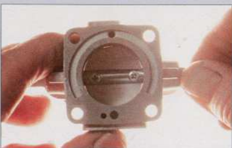
Sichtprüfung: Das Spiel der Drosselklappe hier ist vertretbar. Auf „Null“ arbeiten geht nicht, da dann keine Ausdehnung möglich ist
