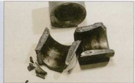
Der Lufttrichter, auch Venturi genannt, muss zum Planziehen des Gehäuses raus. Zinkfraß führt dazu, dass er dabei oft „zerbröselt“
