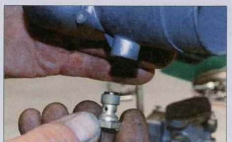
Die Düsen gibt's übrigens bei vielen Bosch-Diensten. Sowohl beim Halter als auch bei der Ablass-Schraube die Dichtringe nicht vergessen
