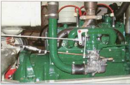
Der Patient im eingebauten Zustand: Hier sieht man schön, dass die Kraftstoffanlage ganz einfach mit Fallförderung arbeitet
