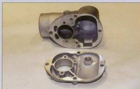
Die Gehäusehälften werden nach dem Glasperlstrahlen auf einem absolut ebenen Untergrund per Hand plan geschliffen
