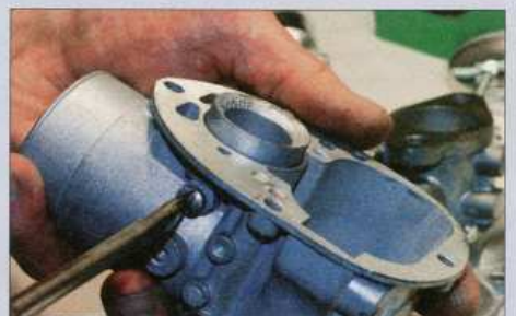
Die Befestigungsschraube hat einen Dorn und fixiert den Venturi in der Höhe. Einige Venturi haben ein Loch, das die Einbautiefe festlegt
