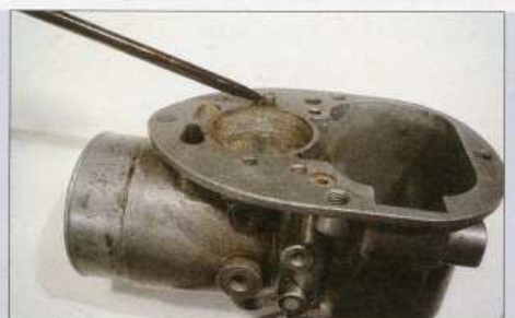
... und die Befestigungsmutter des Mischrohrs. Die Hülse, die die Gehäusehälften passgenau hält, muss raus, um die Dichtflächen...
