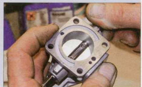
Anprobe: Das Drosselklappengehäuse wird mit neuer Welle und Klappe bestückt. Vor dem Einbau wird die Gängigkeit geprüft
