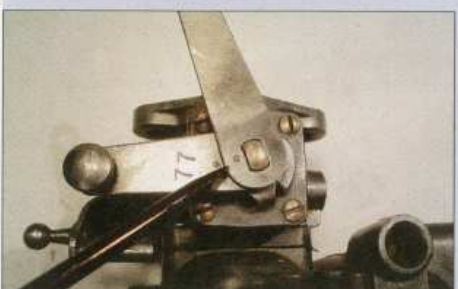
... neu plan zu schleifen. Hier noch mal eine Markierung am Starterhebel, damit beim Zusammenbau nichts verwechselt wird
