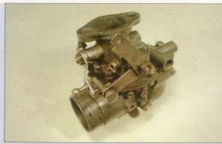
Solex Typ 30 AKV: Es handelt sich um einen einfachen Steigstromvergaser ohne zusätzliche Beschleunigerpumpe oder Choke-Welle
