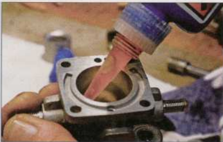
Der Profi nimmt ein Tröpfchen Loctite, ehe er die Schrauben reindreht. Aber Vorsicht, nichts darf auf die Welle kommen, sonst sitzt sie...
