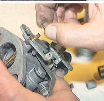
Nach dem Reinigen entfernt Bob die Gasbetätigung und weitere Kleinteile
