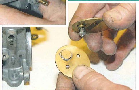
Bimetal-Bypässe in der Drosselklappe erweisen sich als häufige Fehlerquelle. Bob beseitigt die Ventile und verlötet den Deckel
