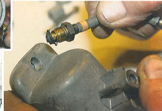
Die ist hinüber: Spätestens beim Demontieren des Düsenstocks zeigt sich echter Arbeitsbedarf
