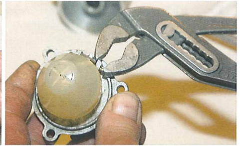
Nach dem Abnehmen des Schwimmerkammerdeckels entfernt der Profi den Befestigungssplint des Schwimmers. Darunter kommt...
