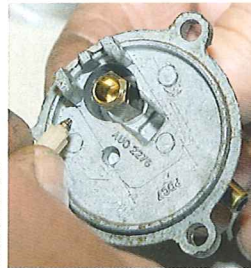
...das Schwimmernadelventil zum Vorschein. Es sollte grundsätzlich komplett erneuert werden
