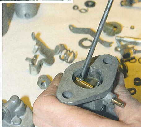
Ist die Drosselklappe ausgebaut, lässt sich die Welle einfach seitlich herausziehen
