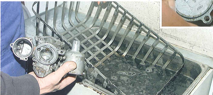
Vor der weiteren Demontage kommen die Teile für zehn Minuten ins Ultraschallbad
