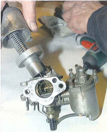
Die Düsenadel wird nach dem Lösen einer Schraube entnommen. Eine eingravierte Nummer kennzeichnet das Nadelprofil
