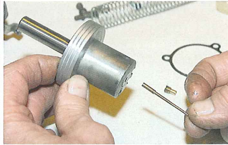
Die Düsenadel wird nach dem Lösen einer Schraube entnommen. Eine eingravierte Nummer kennzeichnet das Nadelprofil
